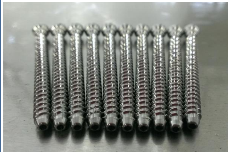
外形加工済製品への深孔加工(Φ1.6 ASTM F136)
