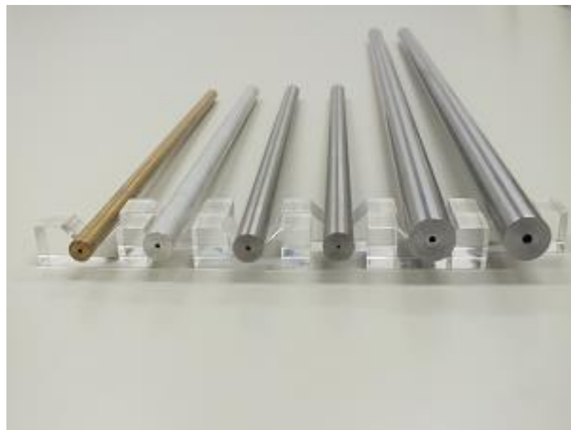
\Phi 1\text{mm} \times 深さ400mm「小径超深孔加工技術」
